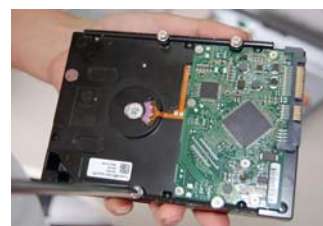
③硬盘上固定四个螺丝（转三圈）
