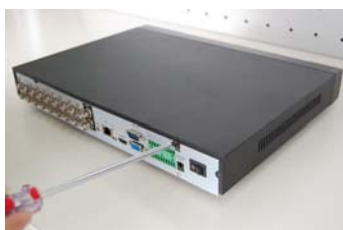
①拆卸主机上盖的固定螺丝
