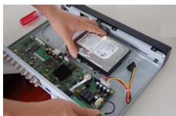
④把硬盘对准底板的四个孔放置
