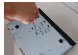
⑥将硬盘固定在底板
