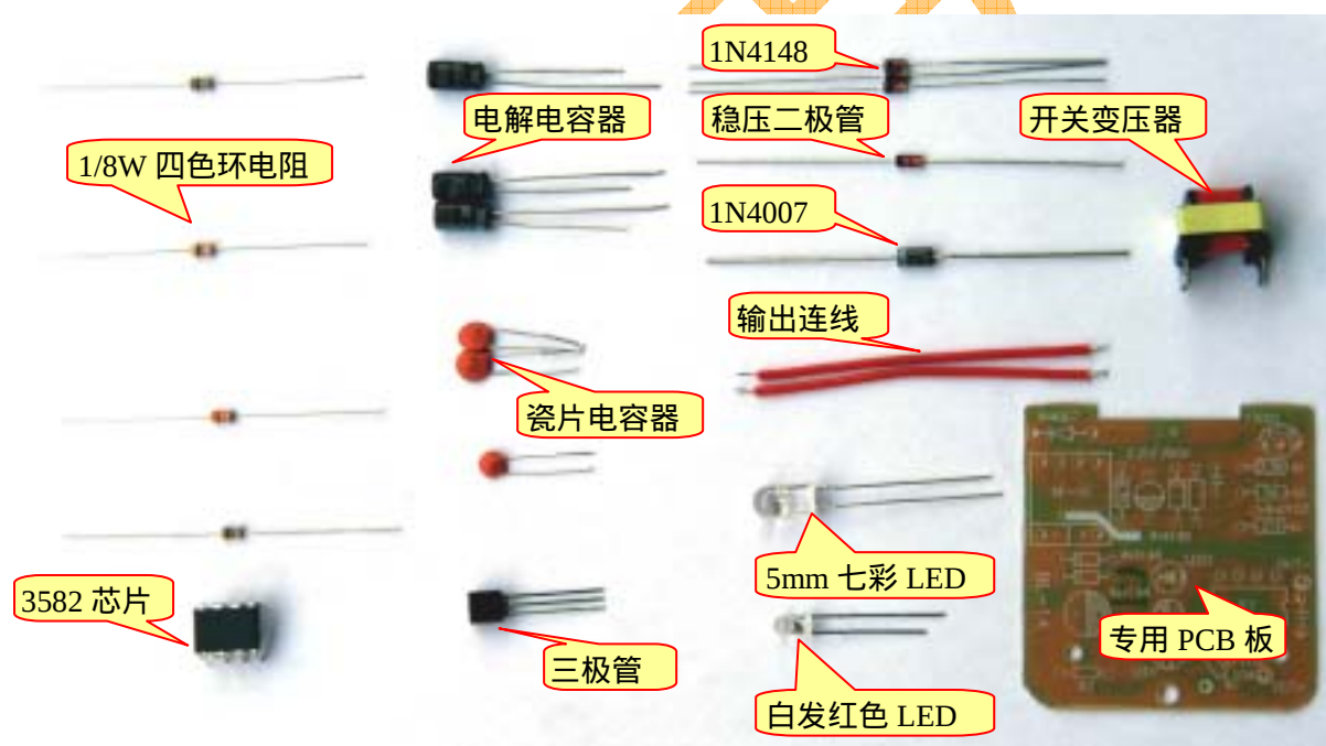
图 2 七彩手机万能充电器元件组成图
